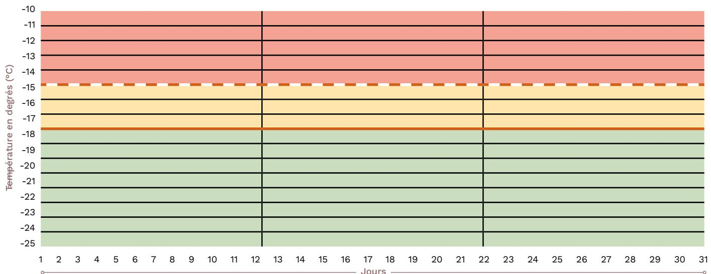
**Mode opératoire :** la lecture de la température peut se faire à l'aide d'un thermomètre placé dans l'enceinte, ou par lecture de l'affichage digital s'il existe. Dans le cas d'une enceinte de capacité >10m<sup>3</sup>, l'enregistrement automatique est obligatoire. La lecture doit se faire de préférence avant la reprise de la production.
